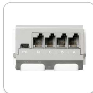
Conexión de motores
