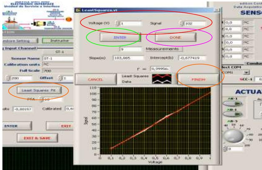
En otros equipos, donde la cantidad de sensores es elevada y del mismo tipo, el software SCADA permite una **MULTICALIBRACION** de todos ellos. Para ello deberá marcar la casilla **Multicalibrate** después de pulsar el botón **CALIBRATE**.
