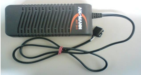
Figura 3-7 Eliminator para recargar las baterías
