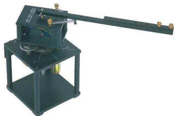
Figura 6-3 Montaje del experimento Junta Flexible
