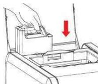
3.- Volver a posicionar el fijador del cartucho presionando hasta escuchar un clic.
