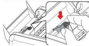
4.- Empuje el filamento a través del tubo guía del filamento hasta el orificio del extrusor y presione la función “LOAD FILAMENT” en el menú de visualización.
