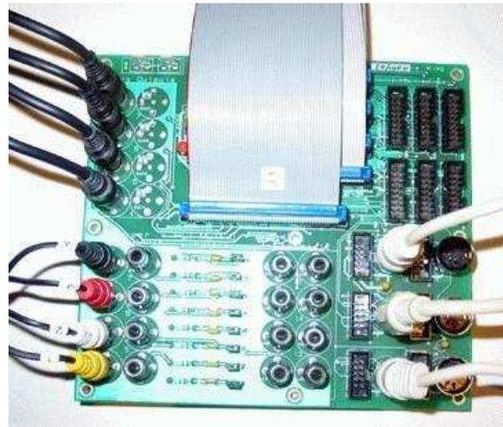
Figura 4-11 Tarjeta de adquisición de datos MultiQ
