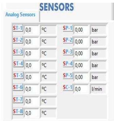
Este panel muestra los indicadores gráficos o numéricos de los datos adquiridos por los sensores. Los indicadores están etiquetados con los nombres de los sensores. La figura muestra un panel típico para una aplicación. En este ejemplo se han leído y se muestran 6 sensores. Algunos de los indicadores gráficos de los sensores puede que se muestren en el panel del centro superior, con el esquema del sistema. Este panel varía dependiendo del equipo
