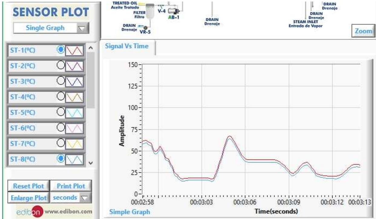
Por otra parte, existe la opción de poder dividir dicha gráfica en dos, para que en cada una de ellas se sitúen sensores de la misma naturaleza, como por ejemplo, en una se pueden visualizar los sensores de temperatura y en la otra los sensores de presión. Para hacer esto sólo debemos usar el control deslizante (“2graphs/1graph”).
