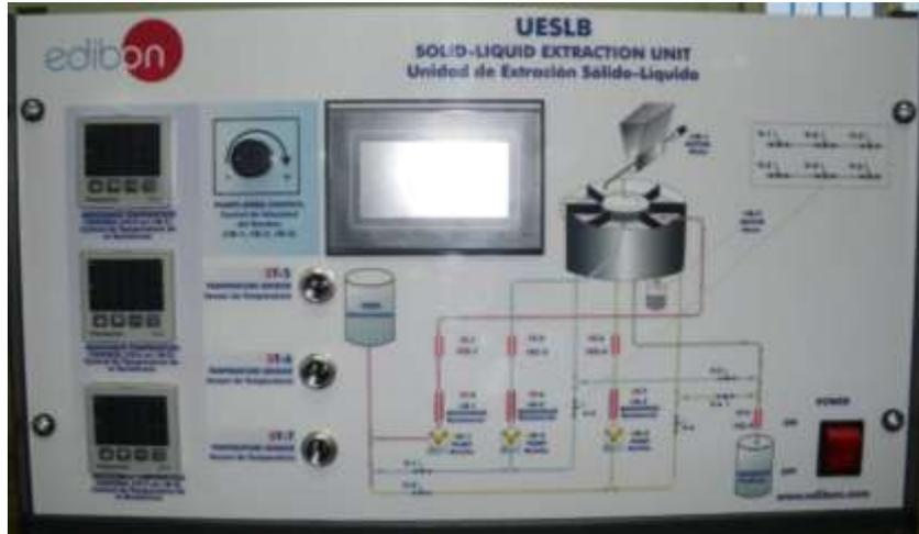
En ambos casos, los sensores se encuentran conectados a la interfaz electrónica (o la consola, en el caso de equipos no computerizados), siendo necesaria una buena conexión de éstos con la interfaz. Para ello hay que asegurarse que los conectores han sido roscados al panel frontal de la interfaz/consola.
