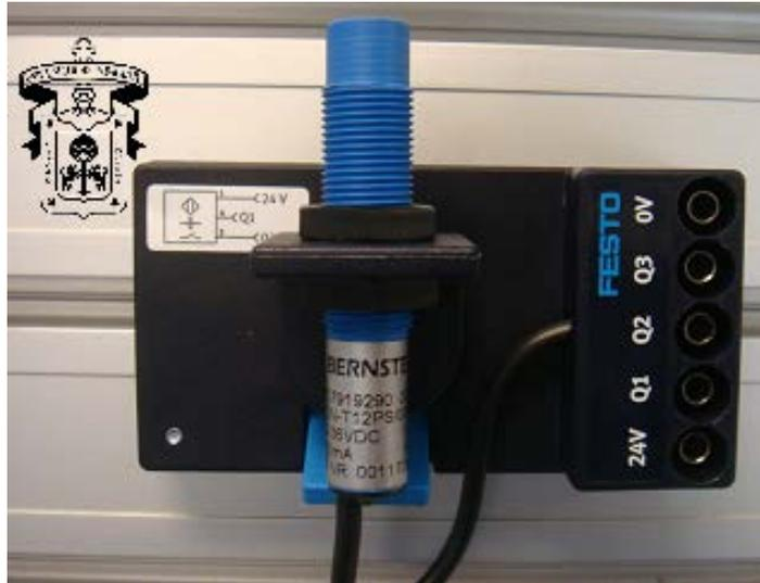
**Fig. 41** Sensor Capacitivo con base didáctica marca FESTO.
